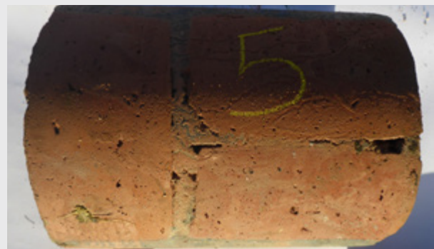
Bild 8: Entnommene Bohrkerne: Beton (oben), Mauerwerk (unten)
