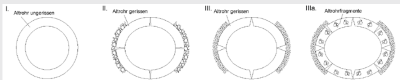
Bild 4: Altrohrzustände (v. l. n. r.): I, II, III und IIIa, Quelle: S&P Consult GmbH
